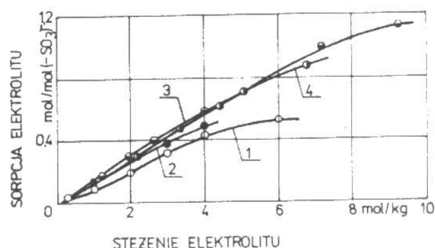
Rys. 2. Zależność sorpcji elektrolitu: 1 – NaCl; 2 – KCl; 3 – NaOH; 4 – KOH przez membranę Nafion 315 od stężenia roztworu zewnętrznego; temp. 298 K.
